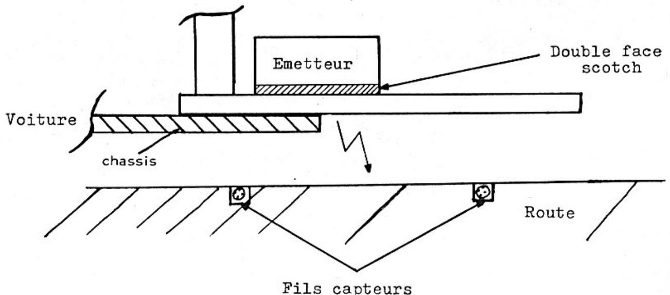
La réception du signal en provenance du petit émetteur est amplifiée une première fois par un petit amplificateur qui se trouve près du fils-capteur et transporté par le câble vers le récepteur Auto Count System. L'auto Count System reçoit le signal, décode le ou les numéros des voitures qui passent sur le fils-capteur et le transmet à l'ordinateur, en l'occurrence AMB 8100 Timing Computer.
