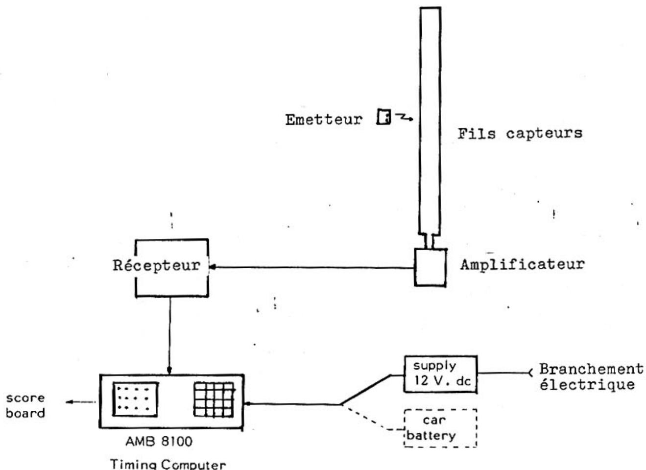
Le petit émetteur du système Auto Count System, mesure 27 x 35 x 9 mm, il ne peut pas créer d'interférence avec les servo-moteur de la voiture. Il est d'une construction très solide et aucune partie extérieur n'est fragile. Il résiste au plus violents chocs. Une fois chargé il peut travaillé environ 24 heures, suffisamment assez pour courir plusieurs jours.
